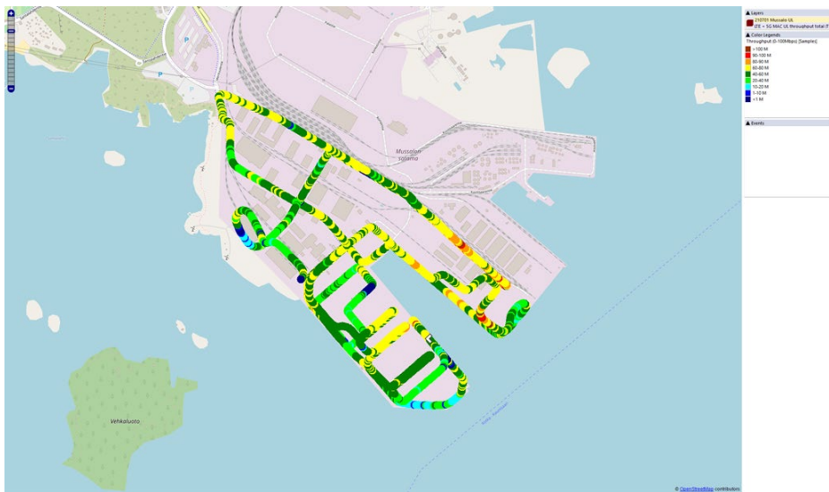
Kuva 3. Total UL throughput (Huawei P40 Pro)
