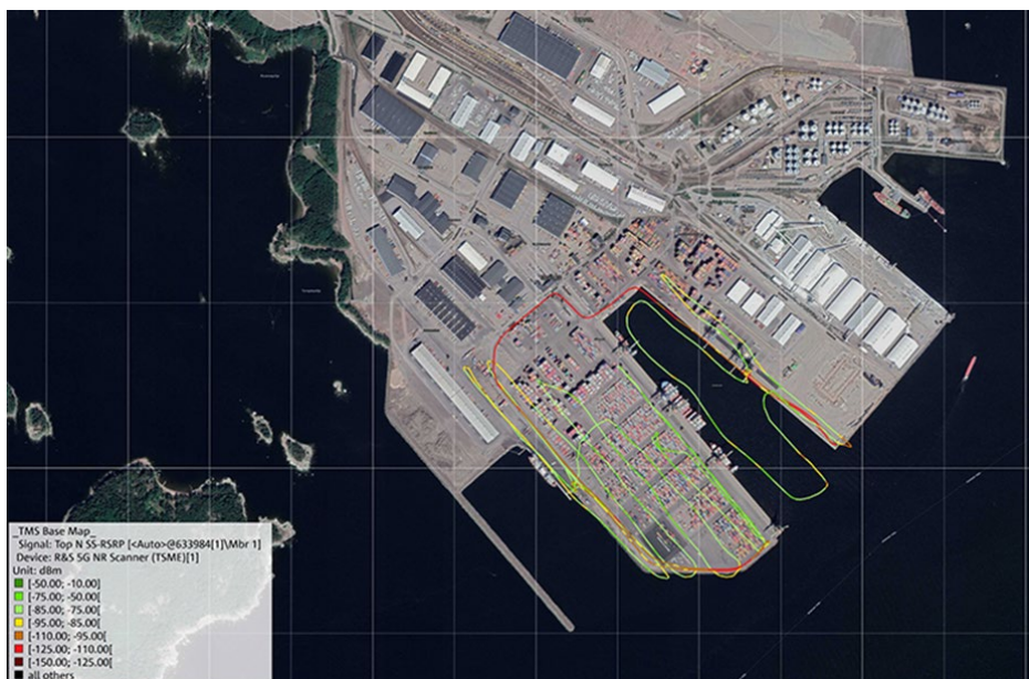
Kuva 6. SS-RSRP mittaus, lentokorkeus 20 m. Punainen viiva kuvaa siirtymistä eri lähtöpaikkojen välillä. Lähde: ROMES4.
