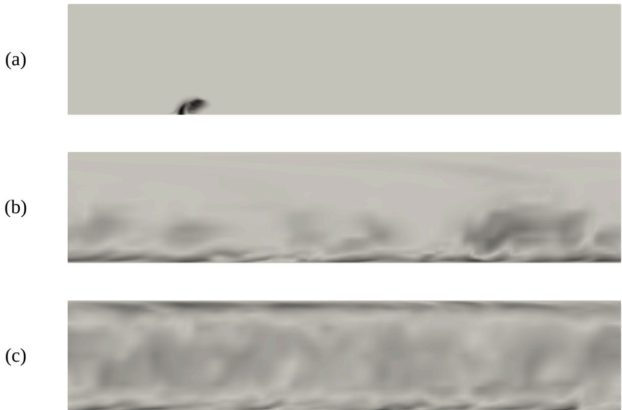
Рис. 4.34 — Амплитуда скорости при M = 6 , Re = 6000 , A = 1 , T = 1 : t = 1 (a), t = 41 (b), t = 81 (c), сечение в продольной плоскости канала через центр возмущения
