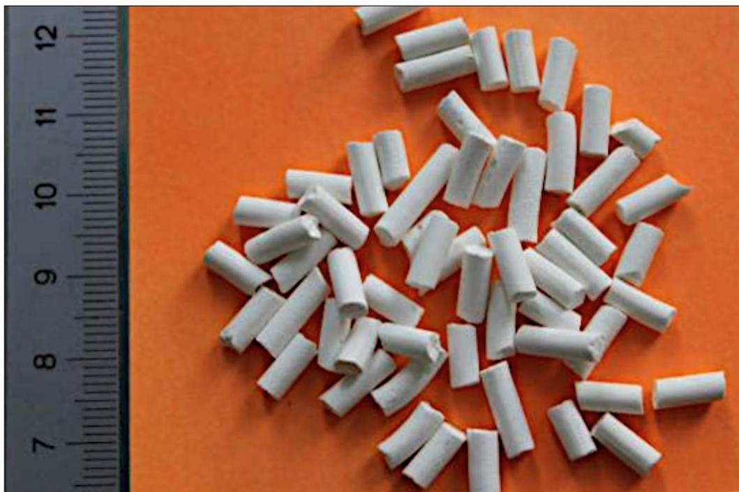
Рисунок А.9 — Фотография композитного сорбента ПБ-15 %МС на основе микросфер МС-В-1Л
