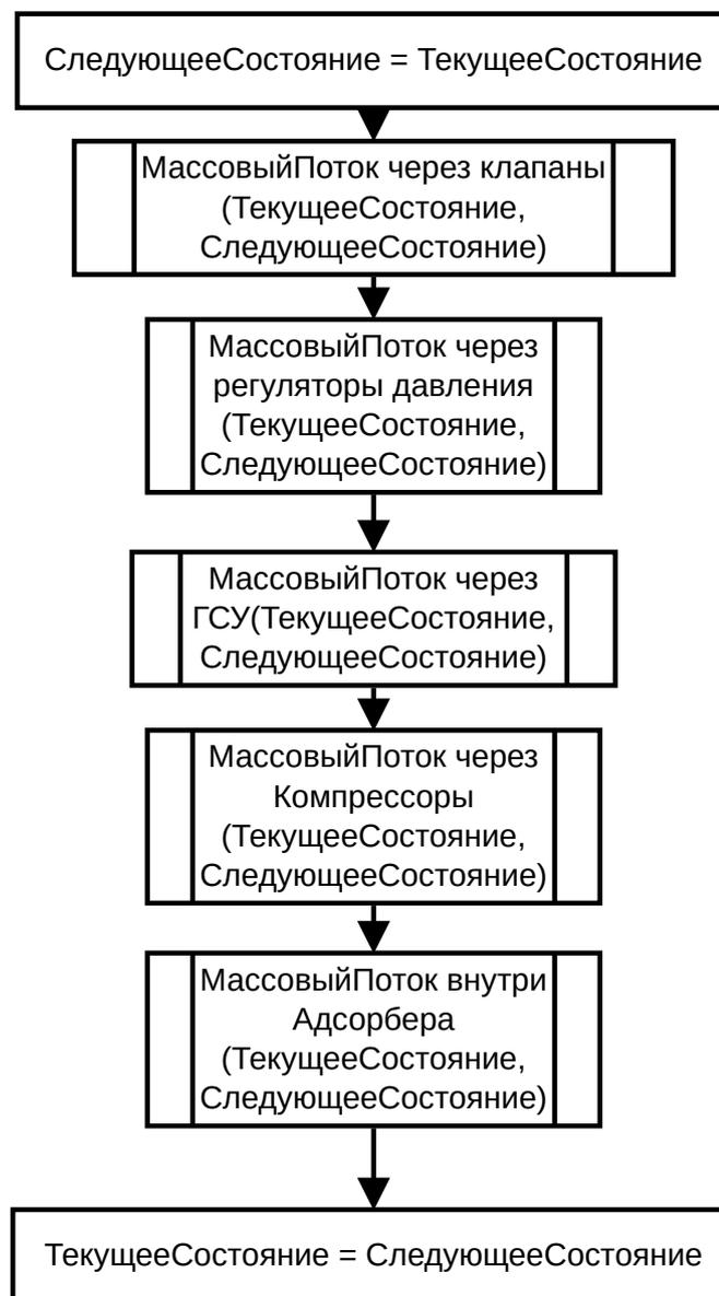
Рисунок 4.11 — Блок-схема алгоритма расчёта массовых потоков между базовыми элементами в системе
