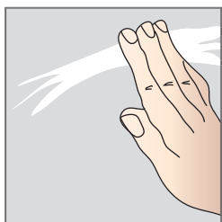
Проверьте стену на наличие извести, губкой смоченной в уксусе
