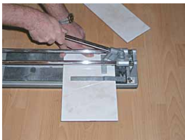
Обрезать и надламывать плитку удобнее в плиткорезе
