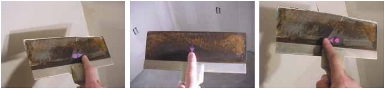
Рис. 27. Способы удерживания шпателя при работе
