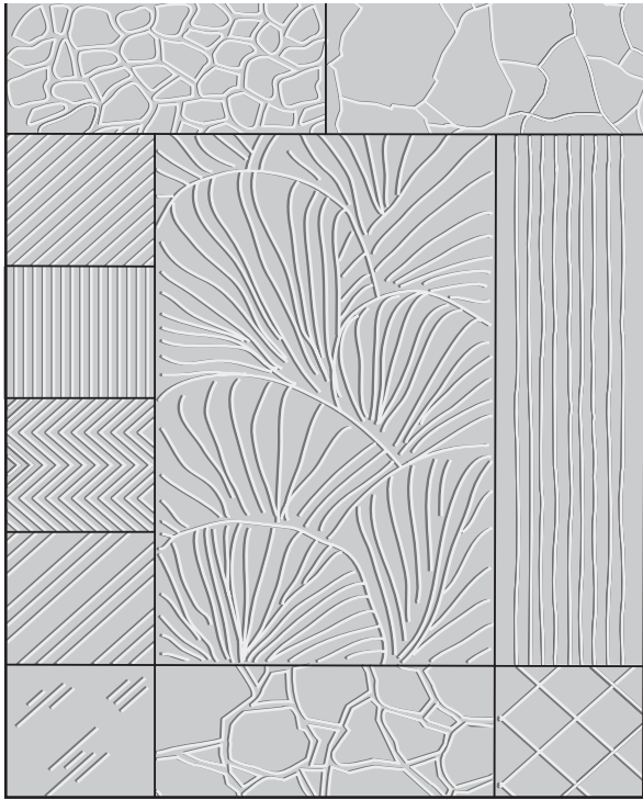
Рис. 26. Отделка полупластичной накрывки царапаньем троянками, циклями, бурчадами (пример штриховок)
