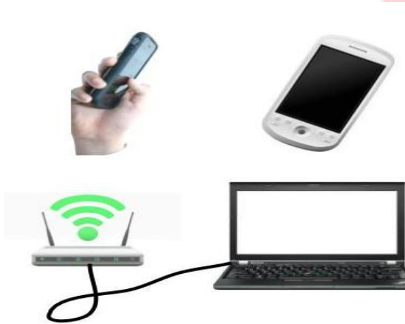
Figura 1. Red LAN inalámbrica formado por el computador del profesor el Punto de Acceso y los dispositivos móviles de los estudiantes.
