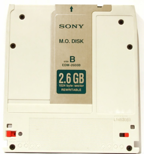
Obr. 6.7: Magnetooptické disky firmy Sony, které využívají ke čtení dat magnetický Kerrův jev. Převzato z webové stránky: http://en.wikipedia.org/wiki/Magneto-optical_drive .
