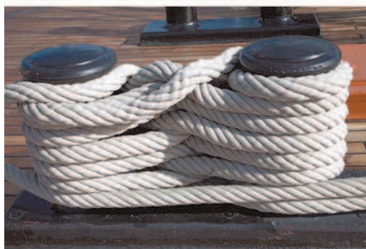
Рис. 2. Причаливание корабля. Внизу изображен кнехт с намотанным на него канатом
