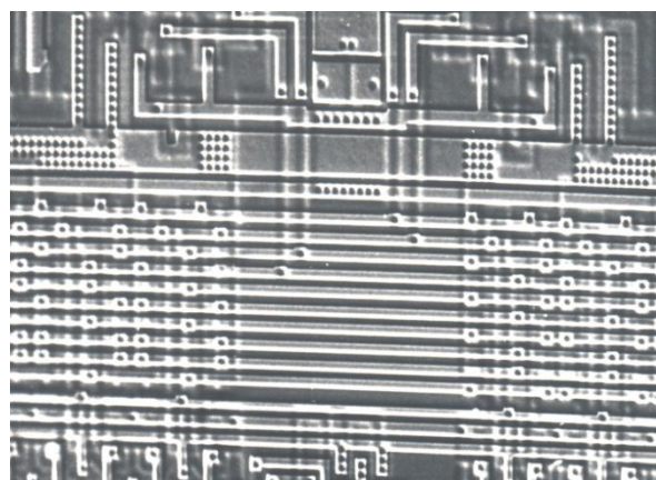
Povrch IO v SEM
