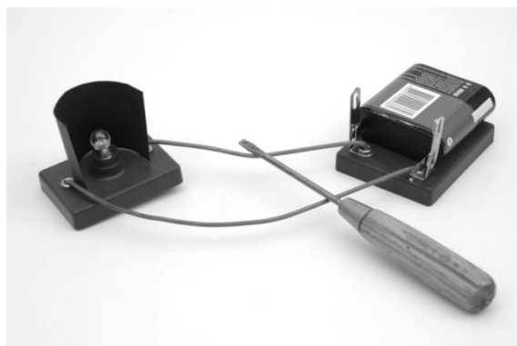
El. obvod – žárovka, plochá baterie, vodiče nejsou izolované. Přes vodiče položen šroubovák – žárovka nesvítí
