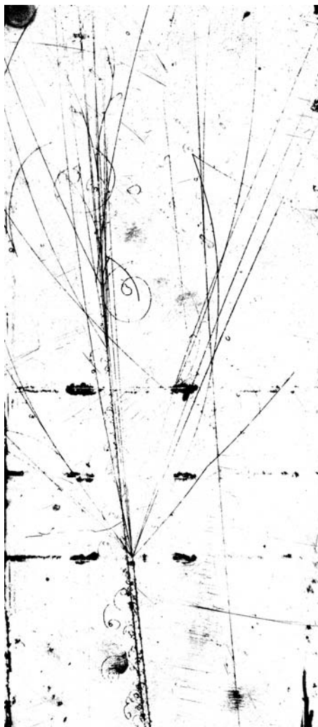
Рис. 16.8. Регистрация событий: пример третий. Пропановая пузырьковая камера с 3-мя танталовыми пластинами-мишенями. Найдите на снимке дельта-электроны, далцевские электрон-позитронные пары. Попробуйте разделить, на глаз, треки заряженных частиц с зарядом 1 и с более высоким зарядом. Разделите вторичные треки на треки положительно заряженных и отрицательно заряженных частиц.
