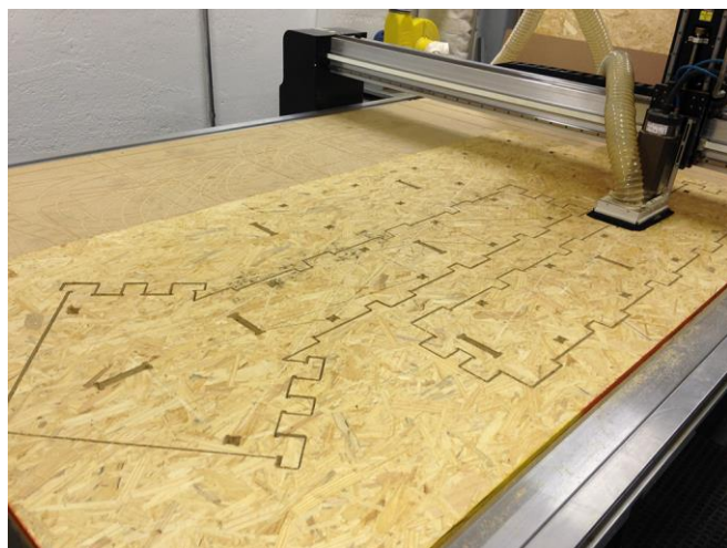
Imagem 6 – Usinagem de componente de um pórtico. As perfurações menores tiveram seu conteúdo completamente subtraído pela fresa. (Pocketing).
