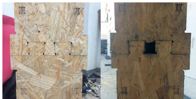
Imagem 8 – Conexão entre componentes. Diferença entre componentes montados com êxito e rompimento por força excessiva na montagem.
