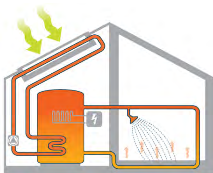
Figur 4-1 Prinsippskisse for solenergianlegg i et bolighus [3].
