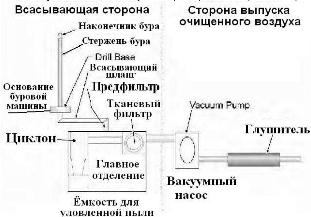
Фиг 4-15 Схема пылеулавливателя, используемого при сверлении отверстий для крепления кровли ↑
