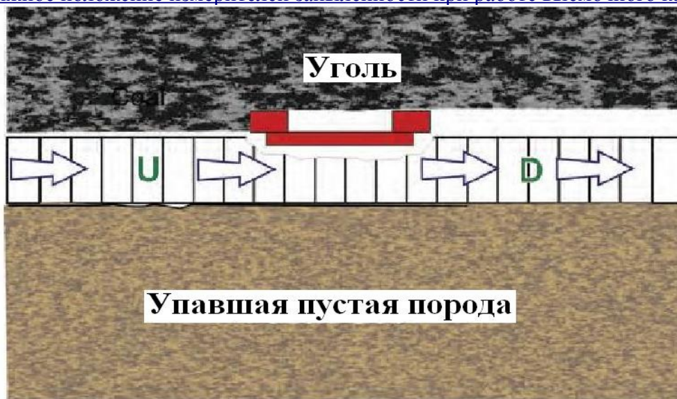
Фиг. 2-5. Подвижное положение измерителей запылённости при работе выемочного комбайна ↑
