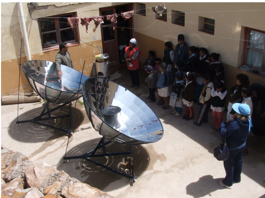
F11.- Conjunto de las cocinas con concentración instaladas en una escuela. Sobresal
