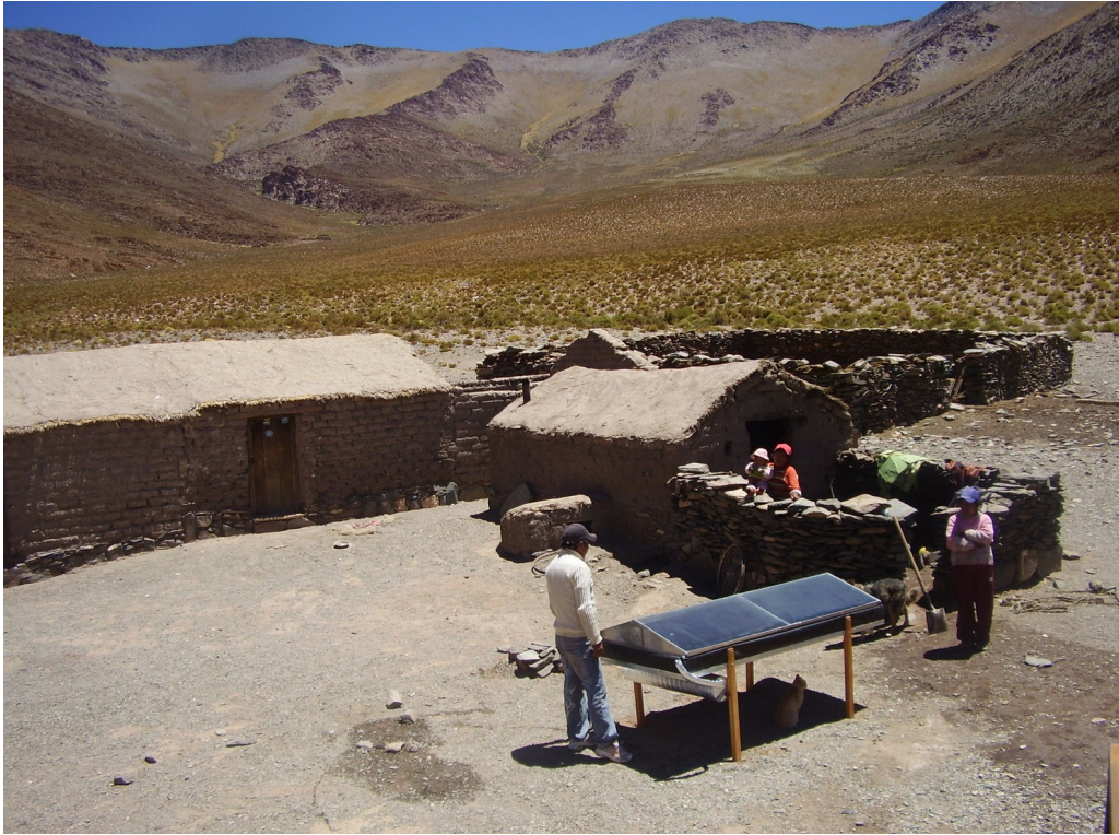
F14.- Destilador solar para producir agua potable en el interior de Salta.
