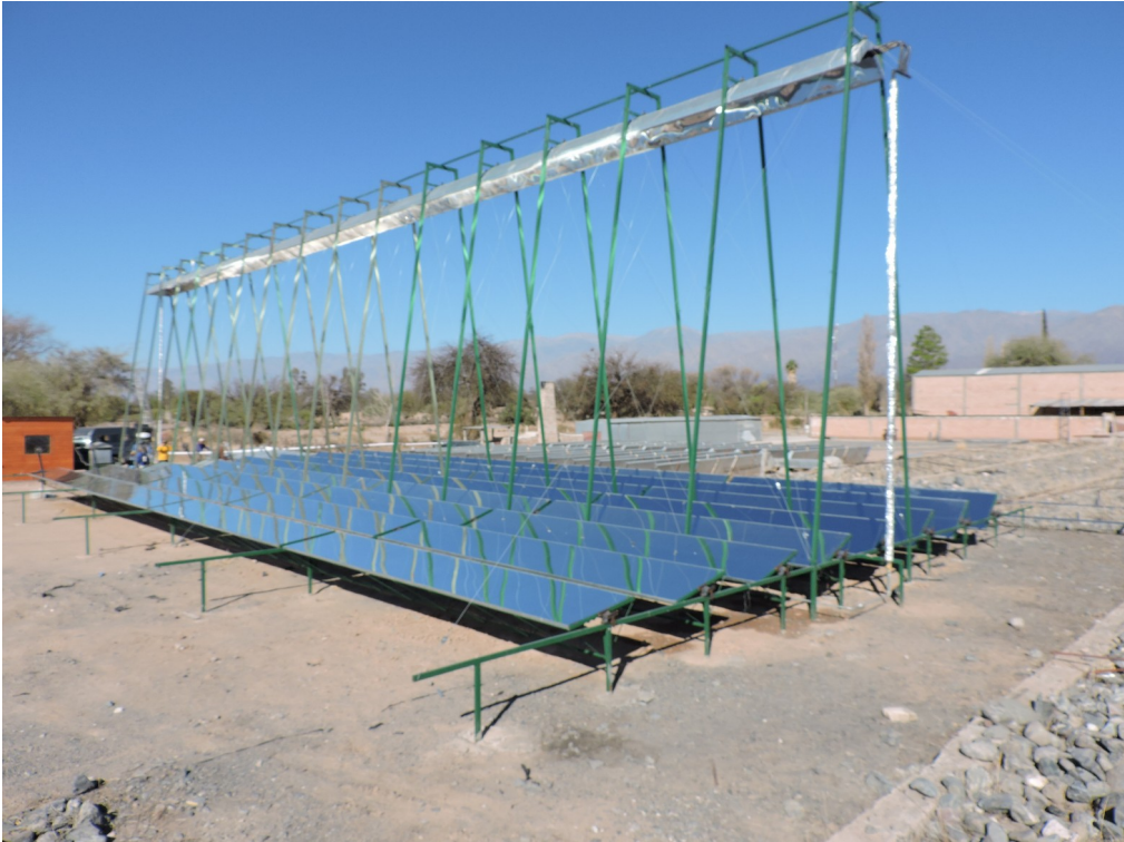
F16.- Generador de vapor Fresnel. Prototipo con 8 espejos y el absorbedor a 7 m de altura.
