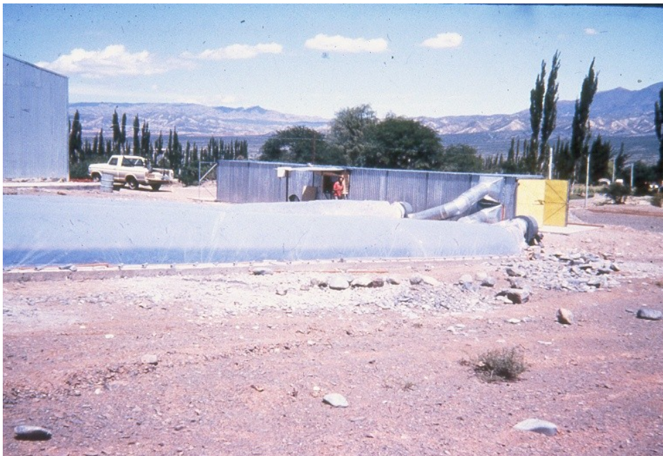
F5-Secador solar en Cachi. Se utiliza un colector solar de plástico. El túnel de secado es de metal y contiene bandejas móviles para el producto.
