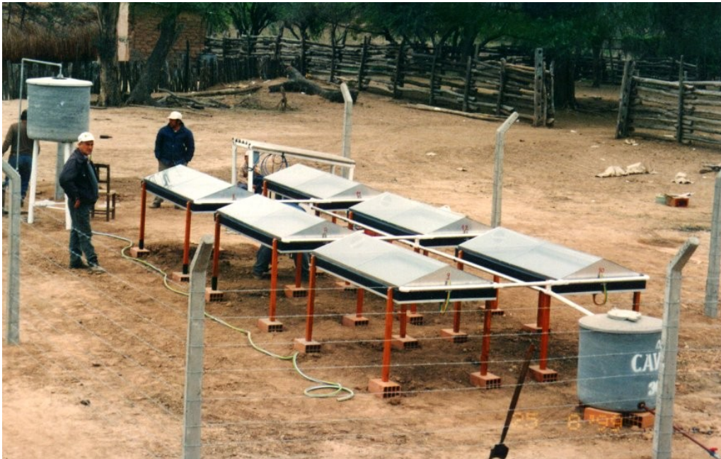
F15.- Conjunto de destiladores solares para un grupo de viviendas en Salta.
