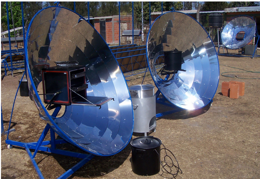
F10.- Conjunto de 2 concentradores con olla y horno, una cocina de leña y una olla adicional para ser entregado a una escuela albergue.
