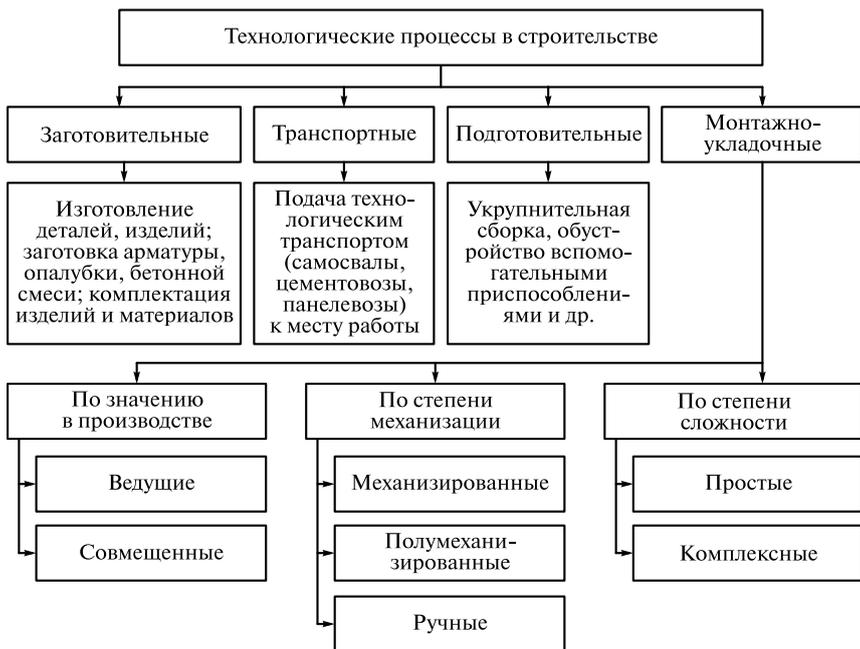
Рис. 1.1. Классификация технологических процессов в строительстве
