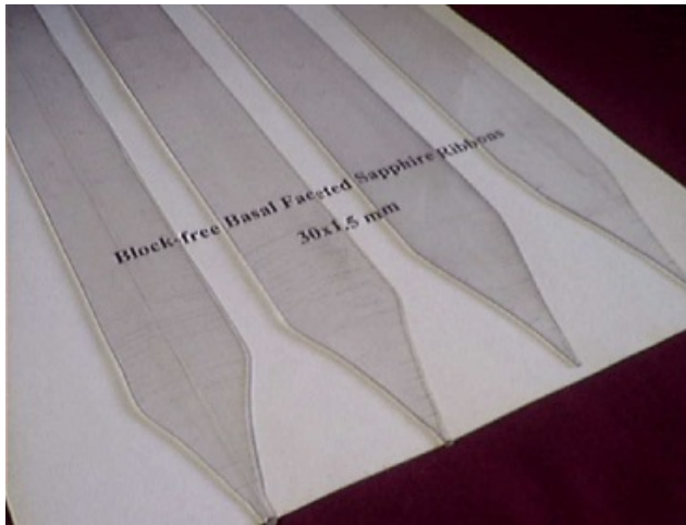
Рис.1. Структурно совершенные сапфировые ленты базисной (0001) ориентации (без блоков).
