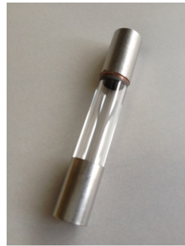
Рис. 2. Газоразрядная лампа, изготовленная из сапфировой трубки.
