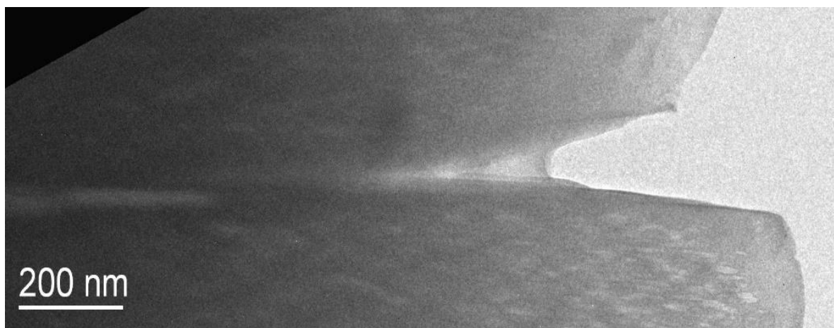
Рис. 1. Трещины в тонких фольгах подросткового коронкового дентина для просвечивающего электронного микроскопа
