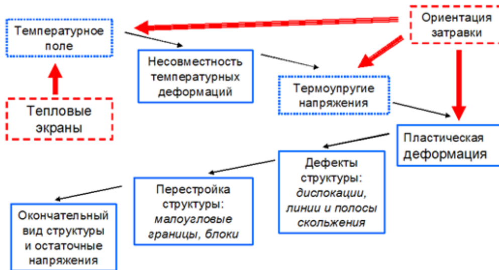
Рис.1. Общая схема образования дефектов структуры при выращивании кристаллов из расплава
