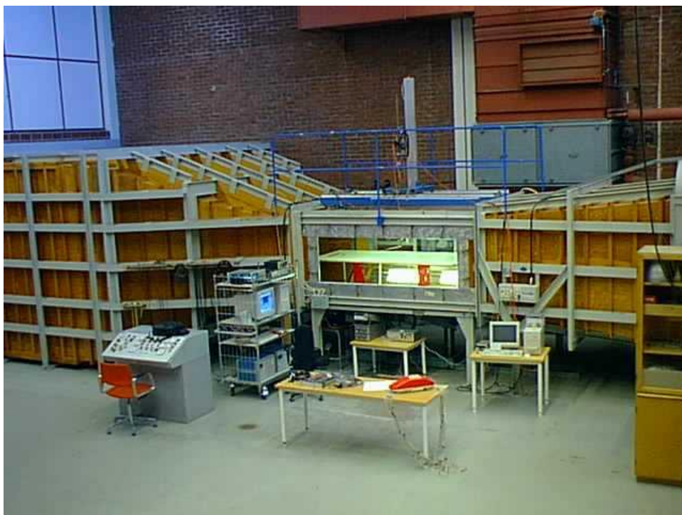
Рис. 2.1. Схема малотурбулентной аэродинамической трубы L-2 Чалмерского Технологического Университета г. Гетеборг (Швеция)
