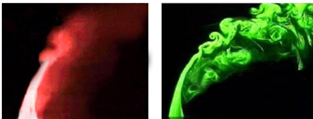
Рис. 6.14. Визуализация дымом струи в пограничном слое при K = U_{\text{струи}} / U_0 \approx 3 в настоящем эксперименте (слева) и визуализация струи в пограничном слое в водяном канале при K = U_{\text{струи}} / U_0 \approx 3,5 из работы [155] (справа)
