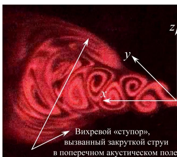
Рис. 7.26 Картина дымовой визуализации процесса развития плоской микроструи в поперечном акустическом поле ( f = 100 Гц)
