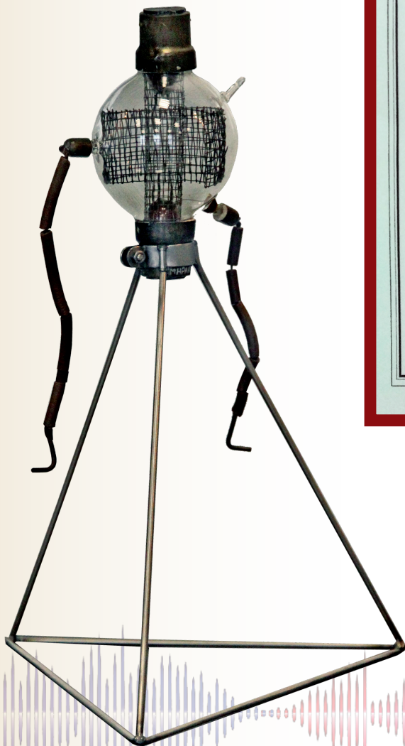
Катодное реле конструкции М.А. Бонч-Бруевича (лампа «Бабушка») в экспозиции музея «Нижегородская радиолaborатория»
