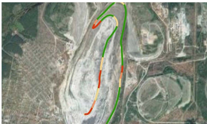
Оценка качества дорожных условий по результатам обработки данных системы ограничения динамических нагрузок
