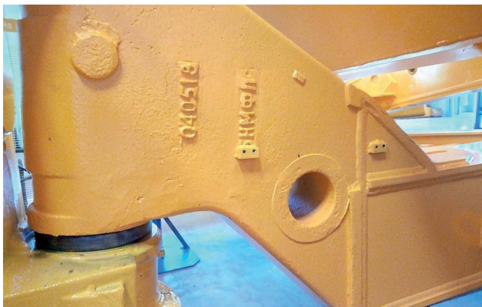
Отливка оси карьерного самосвала с термоупрочненными наконечниками из стали 15НМФЛ
