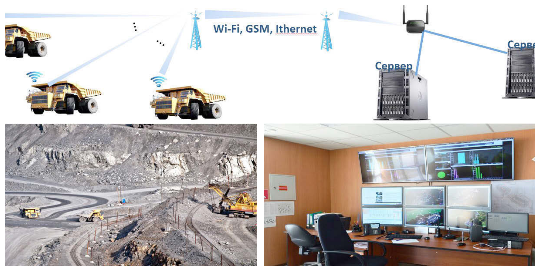
Структура базовой части системы ограничения динамических нагрузок
