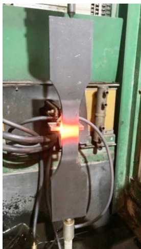
Процесс СЭТО образца со сварным соединением из стали 10ХСНД
