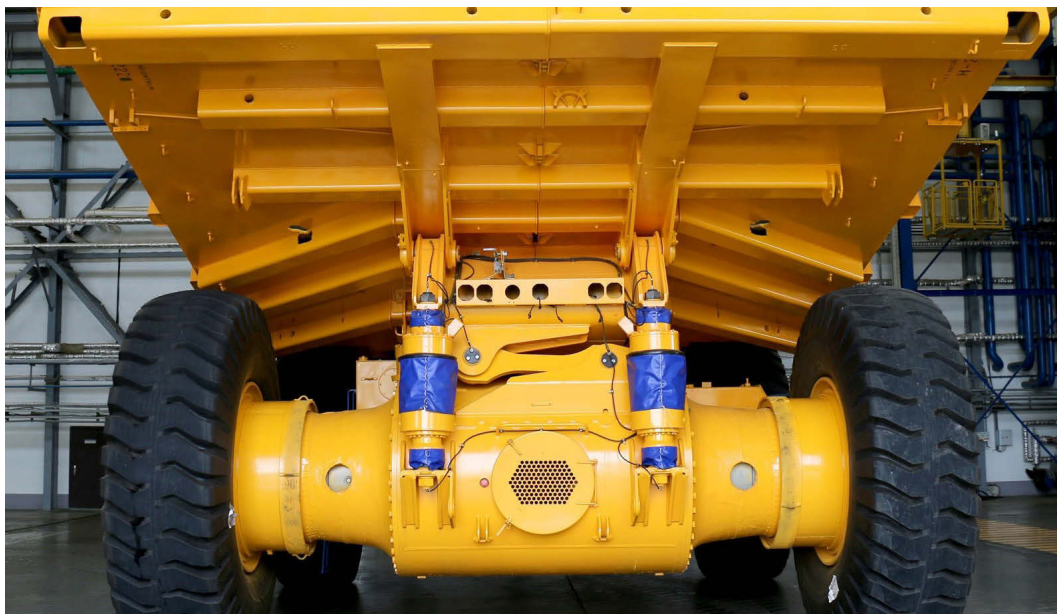
Задняя подвеска карьерного самосвала БЕЛАЗ-75131
