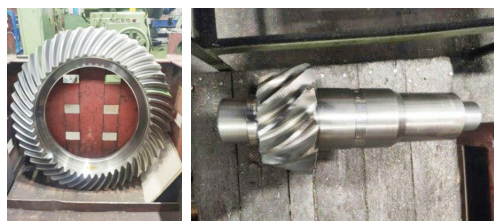
Экспериментальные конические зубчатые колеса карьерных самосвалов из стали 20ХН3А, микролегированной ванадием
