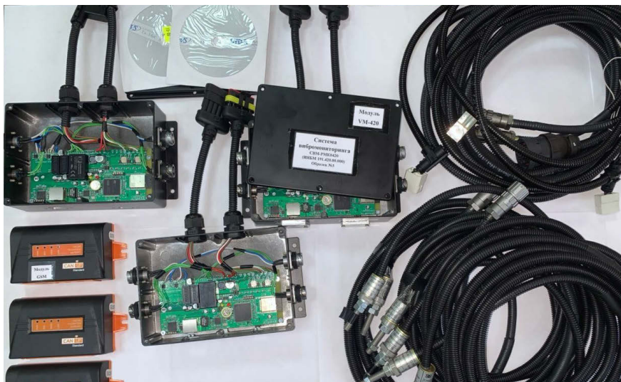
Комплекты модернизированной системы вибромониторинга PMK карьерных самосвалов с беспроводной передачей данных (CBM-PMK-420)
