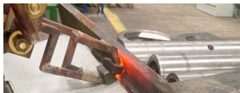
Процесс СЭТО сварных соединений (швов) элемента рамы карьерного автосамосвала
