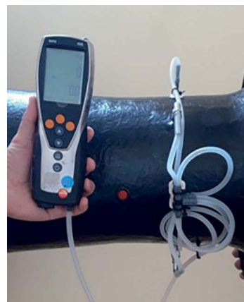
Стендовые измерения статического и динамического давления, развиваемого вентилятором системы охлаждения карьерного самосвала
