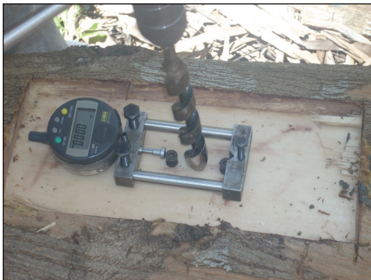
Figura 1. Instrumento para medir el indicador de la tensión de crecimiento, GSI , según el método CIRAD-Fôret.
