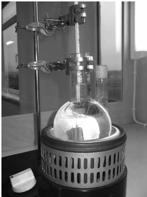
Joonis 3. Vee kuumutamine kolvis koos magnetseadmega
