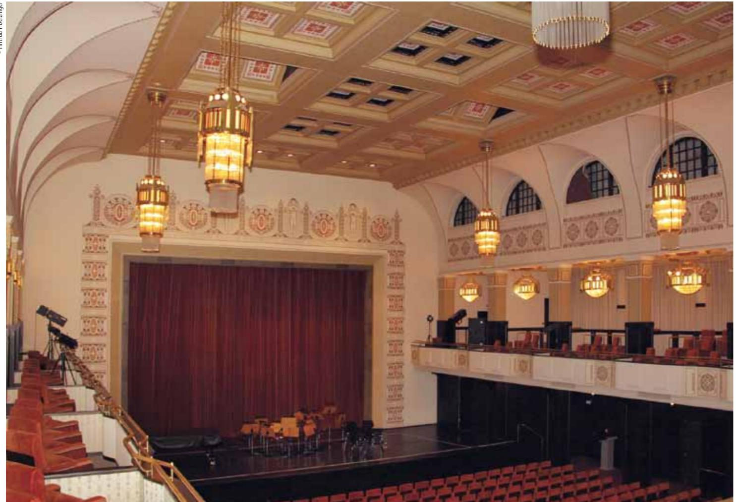
*The concert hall: note the ceiling panels that can be opened for ventilation**Vista general de la sala de concerts del teatre: cal destacar els plafons del sostre que es poden obrir per ventilar la sala*
