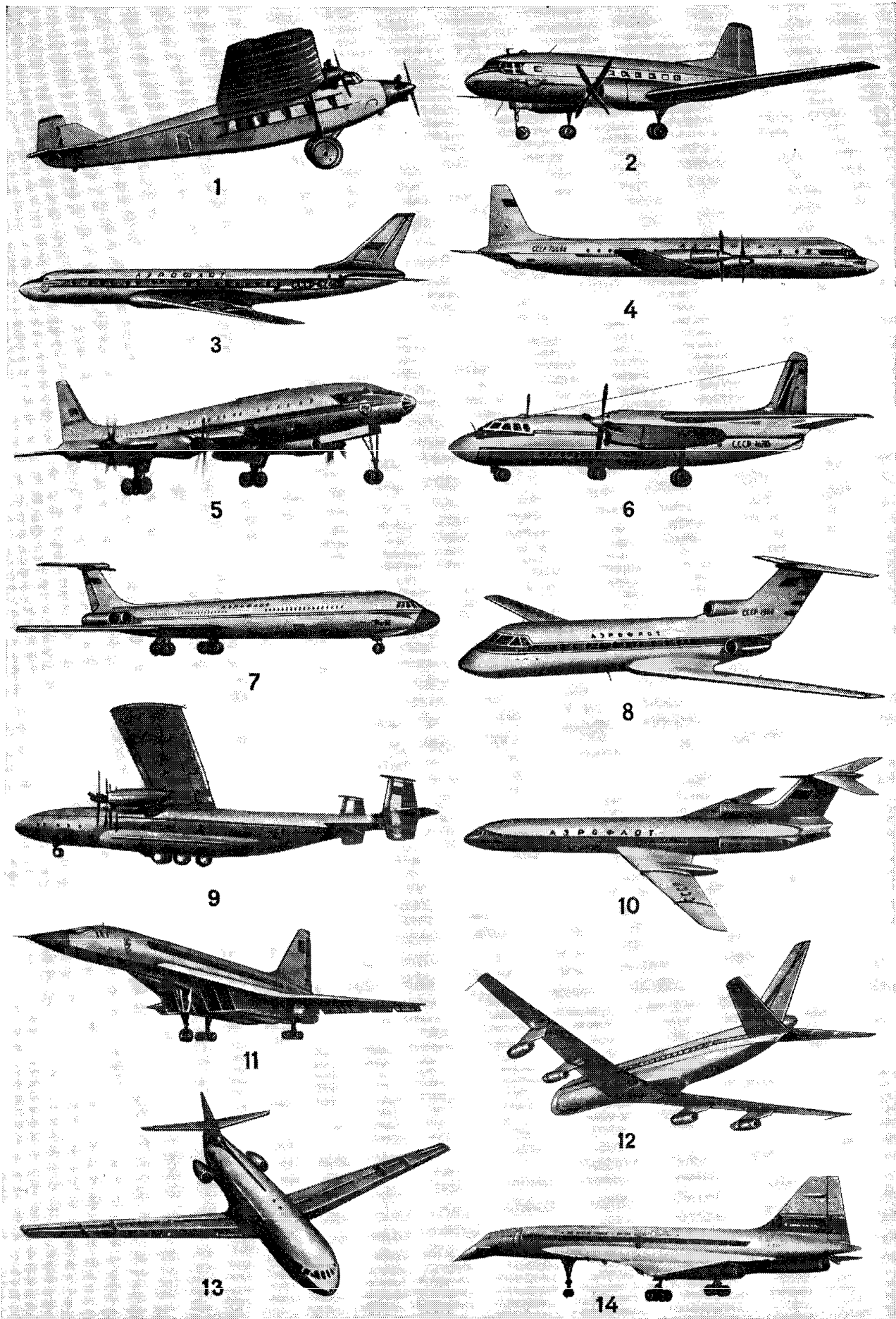
Самолёты гражданской авиации: 1 — АНТ-9 — один из первых серийных советских пассажирских самолётов; 2 — пассажирский самолёт Ил-14; 3 — пассажирский турбореактивный самолёт Ту-104; 4 — пассажирский гурбовинтовой самолёт Ил-18; 5 — пассажирский турбореактивный самолёт Ту-114; 6 — пассажирский самолёт Ан-24; 7 — пассажирский турбореактивный самолёт Ил-62; 8 — пассажирский турбореактивный самолёт Як-40; 9 — транспортный турбовинтовой самолёт Ан-22 («Антей»); 10 — пассажирский турбореактивный самолёт Ту-154; 11 — сверхзвуковой пассажирский самолёт Ту-144; 12 — пассажирский турбореактивный самолёт DC-8 (США); 13 — пассажирский турбореактивный самолёт «Каравелла» (Франция); 14 — сверхзвуковой пассажирский самолёт «Конкорд» (Франция, Англия).
