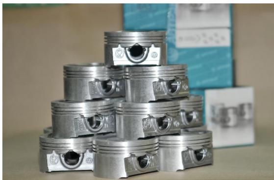
Поршни определяют ресурс любого двигателя. Поэтому на «АВТРАМАТ» применяется многоуровневая система контроля, охватывающая весь технологический процесс, начиная со спектрального и химического анализа состава сплава и заканчивая обмером и взвешиванием готовых деталей.
