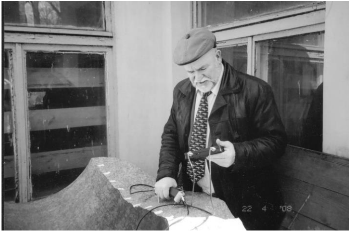
Профессор Е. М. Нестеров проводит ультразвуковое зондирование вазы (А.Б.)
