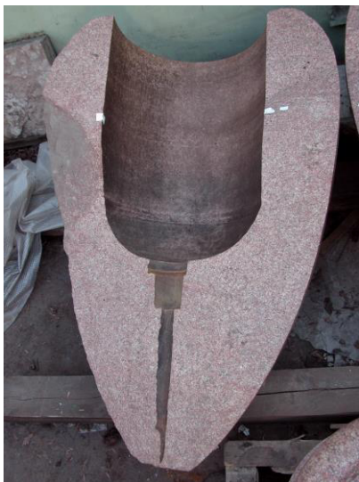
Трещина с биопоражениями и свежий гранит (А.Б.)
