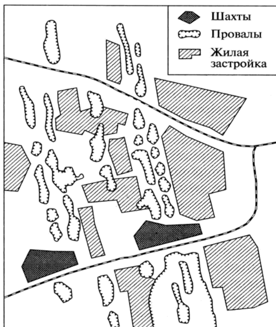
Рис. 1.63. Характер использования территории в зоне подработок угольных пластов, Кузбасс (Перцик, 2009)
