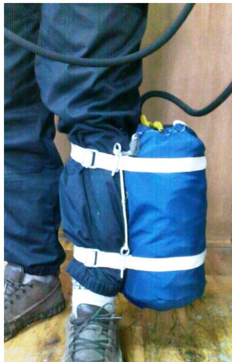
Фото 8.2.27. Вариант специального ножного чехла «Банан» с устройством быстрого сброса
