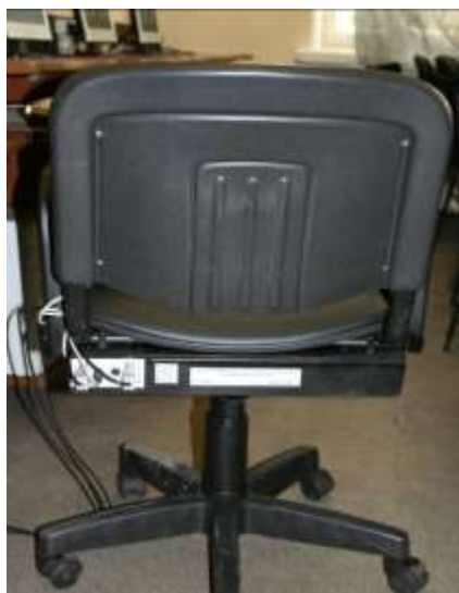
Рис. 2а. Стабилографическое кресло; под сиденьем – блок с датчиками.
