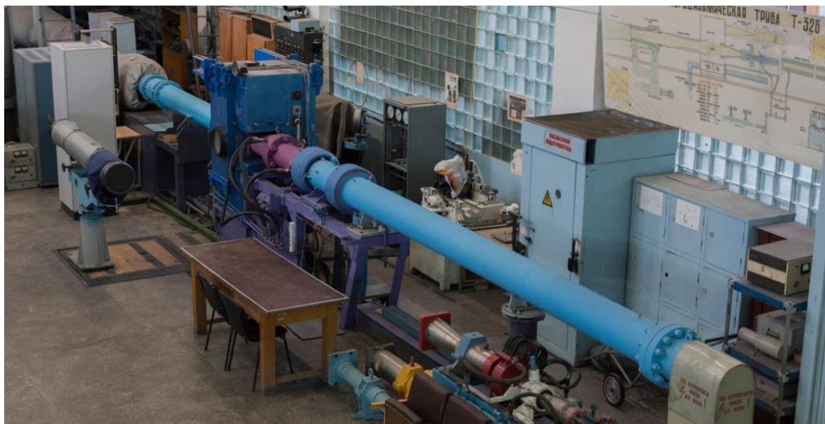
Рис. 23. Высокоскоростная сверхзвуковая аэродинамическая труба Т-326 ИТПМ СО РАН.
