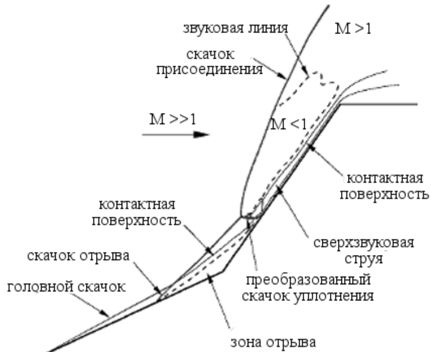
Рис. 12. Структура сверхзвукового течения на двойном конусе ([46], рис. 1b).
