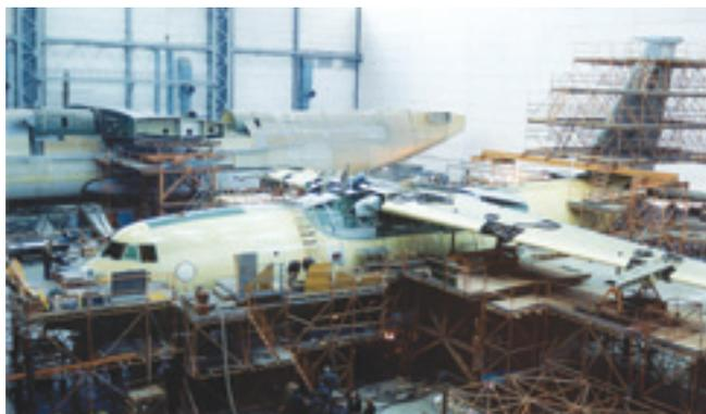
**Сборка второго Ан-70. На заднем плане фюзеляж второго Ан-225**
