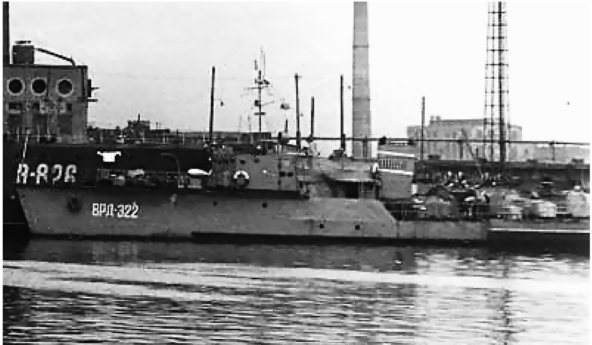
Рейдовый тральщик Т-372, переоборудованный в водолазный бот ВРД-322
