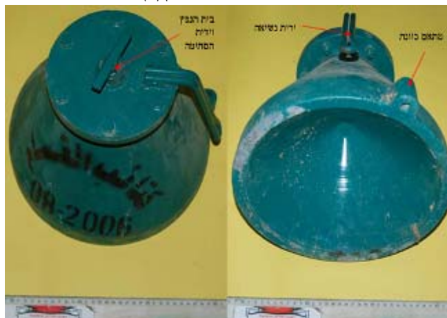
Кумулятивный заряд "Шаваз", самостоятельно производимый Хамасом и обнаруженный 12 сентября 2006 года. Приблизительная бронепробиваемость: более 200 мм (сталь).
