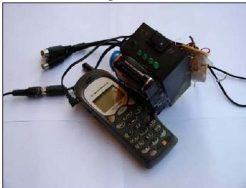
Беспроводное детонирующее устройство на базе сотового телефона предназначено для последовательного подрыва до четырех самодельных взрывных устройств
