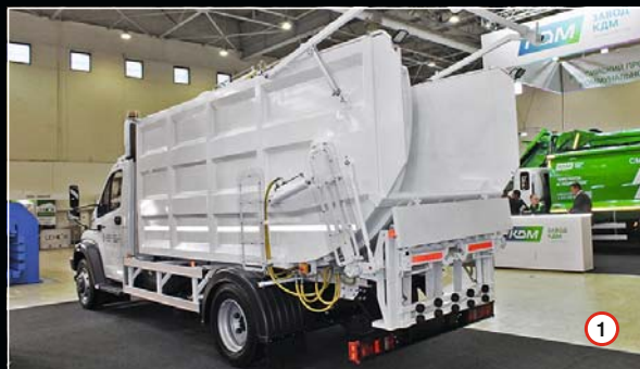
1. Мусоровоз ГАЗ-САЗ-3901-19 на шасси «Газон Next». 2. ГАЗ-САЗ-3901-16 на шасси грузовика «Валдай» на два метра короче капотного собрата.
