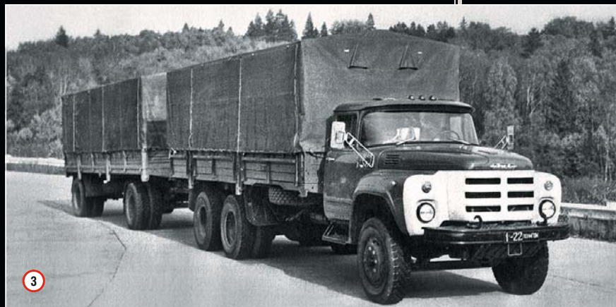
1. ЗИЛ-133Г40 в варианте мусоровоза. 2-3. В отличие от бензиновых предшественников, не рассчитанных на буксировку прицепов, получивший камский силовой агрегат ЗИЛ-133ГЯ мог эксплуатироваться в составе автопоезда массой 29,3 тонны.
