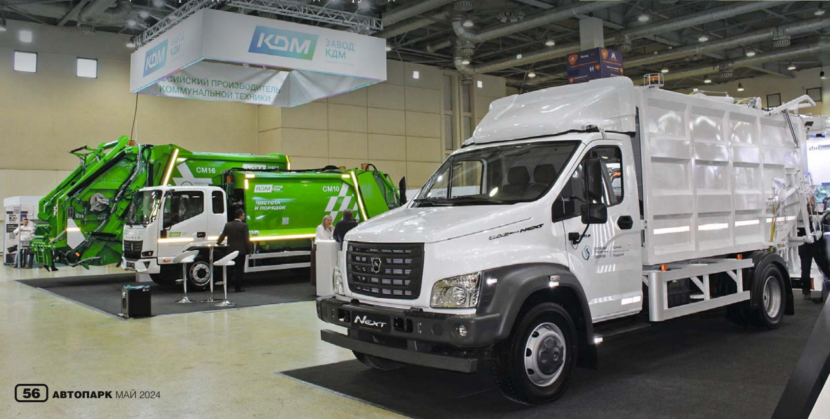
1. Мусоровоз ГАЗ-САЗ-3901-19 на шасси «Газон Next». 2. ГАЗ-САЗ-3901-16 на шасси грузовика «Валдай» на два метра короче капотного собрата.
