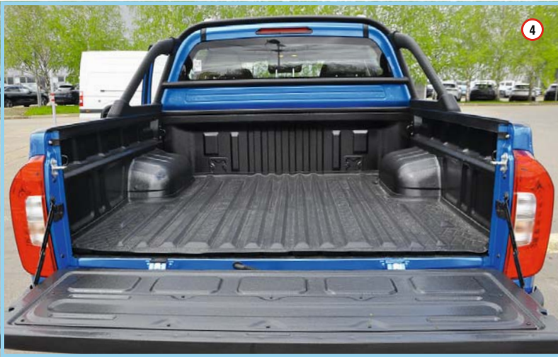
4. Кузов размерами 1520x1580x440 мм. Хорошо виден резиновый поддон.
