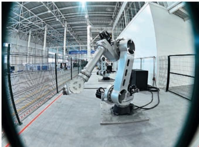
✕ **Производство началось с выпуска механической «руки» грузоподъемностью 120 килограммов.**
