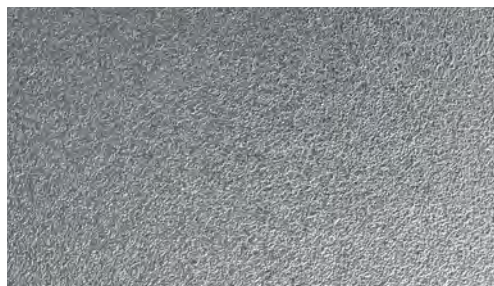
Mustergewalzte Oberflächen verbinden Reflexarmut mit Reinigungsfreundlichkeit. Fotos: Aperam
