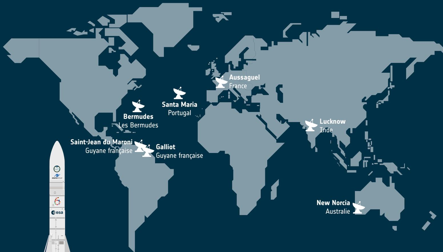
La poursuite de la fusée vise deux objectifs principaux. Il s'agit d'abord de déterminer avec précision la trajectoire et le fonctionnement en vol. Cela permet ensuite de déclencher des alarmes et de prendre d'éventuelles mesures de sauvegarde si les choses ne se passent pas comme prévu. Un vaste réseau d'antennes destinées à suivre le lanceur est déployé à travers le monde, il inclut des antennes du CNES, du réseau Estrack de l'ESA et de partenaires.
