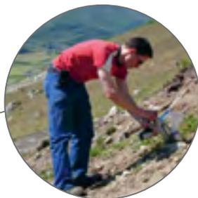
Der Bleigehalt in einer Bodenprobe wird mit einem mobilen Röntgen-Fluoreszenz-Gerät gemessen.
