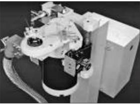
자동차 선박 기계 등을 만드는 과정에서 다양한 금속 재료를 접합할 때 로봇 용접기가 쓰인다. 수백 차례 용접하면 용접기 끝부분(용접팁)에 다양한 금속 물질이 녹아 붙고 고온 영향으로 용접팁도 변형돼 용접 품질이 떨어지기 마련이다. 이때 용접팁을 깎고 다듬어 용접기의 성능을 원상회복시키는 게 산업용 용접팁 연마기의 역할이다.
