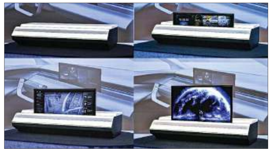
현대모비스가 세계 최초로 개발한 차량용 롤러블 디스플레이. 네 가지 주행 모드에 따라 화면 크기를 조절할 수 있다. 최대 30인치 화면으로 확장도 가능하다. 현대모비스 제공
