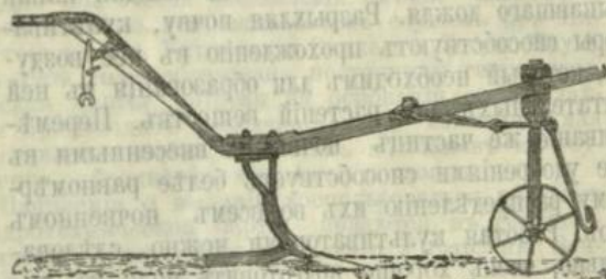
Рис. 1. Почвоуглубитель Сапка съ одноколеснымъ перед-омъ. Со склада Т-ва «Работникъ».
