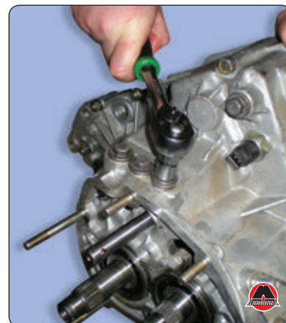
25. Извлечь пружину вместе с шариком.
