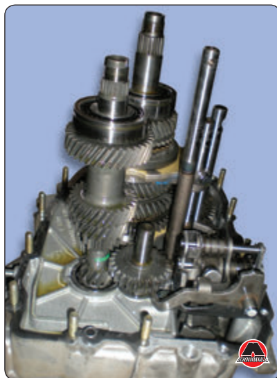
30. Снять корпус коробки передач.
