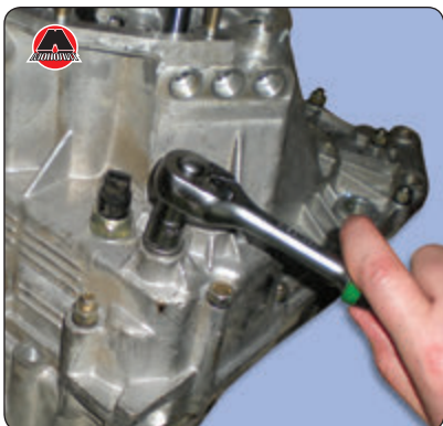
28. Отвернуть все гайки крепления корпуса коробки передач к картеру сцепления.
