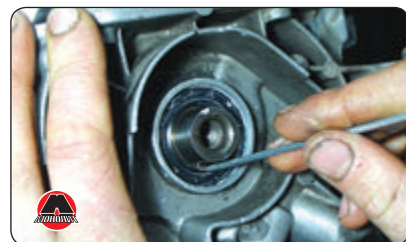
Примечание При установке с помощью шила заправить сальник.
