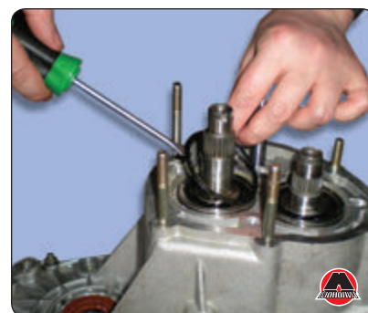
24. Отвернуть болт фиксатора штока.
