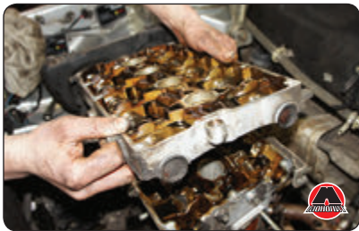
51. Магнитом извлечь гидрокомпенсаторы из посадочных мест.
