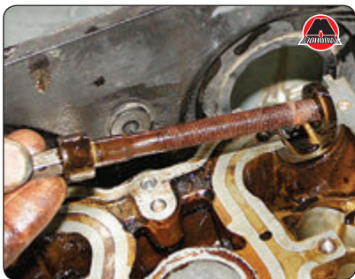
54. Снять головку блока цилиндров и положить ее на верстак.
