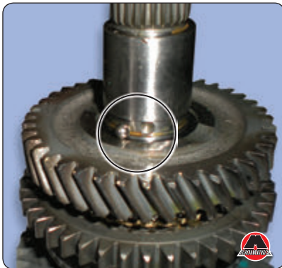
16. Снять шестерню второй передачи.
