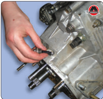
26. Выкрутить оставшиеся болты фиксаторов.
