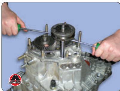
14. Снять коническое кольцо синхронизатора со вторичного вала.
