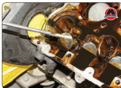
52. Отвернуть десять болтов крепления головки блока цилиндров в указанной последовательности (см. фото ниже).
