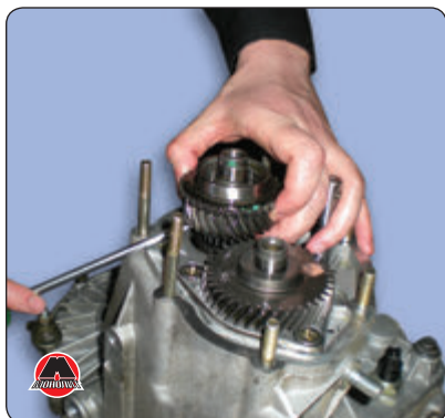
16. Используя отвертку, снять ведущую шестерню пятой передачи с первичного вала.
