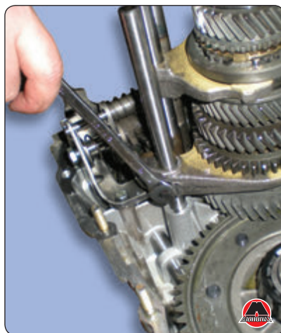
32. Вывести вилку включения из муфты синхронизатора, затем снять вместе со штоком.
