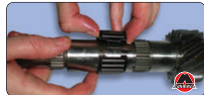
23. Снять с вала игольчатый подшипник, как показано на фото ниже.
