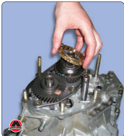
15. Используя отвертку, приподнять и снять ведомую шестерню пятой передачи с вторичного вала.
