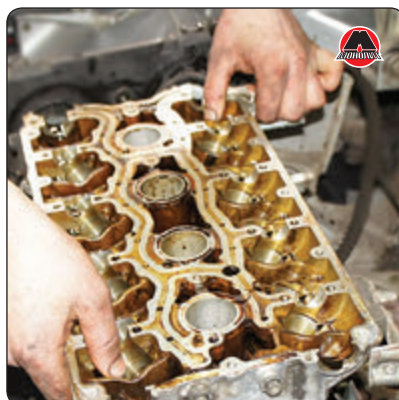
54. Снять головку блока цилиндров и положить ее на верстак.
