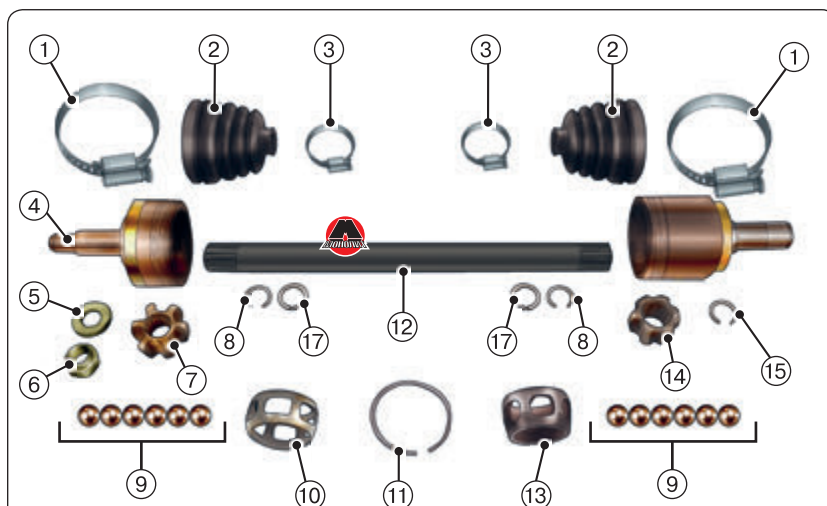
1. Большой хомут крепления пыльника ШРУСа, 2. Пыльник ШРУСа, 3. Меньший хомут крепления пыльника ШРУСа, 4. Корпус наружного ШРУСа, 5. Упорная шайба, 6. Гайка крепления, 7. Внутренняя обойма наружного ШРУСа, 8. Стопорное кольцо, 9. Шарики ШРУСа, 10. Сепаратор наружного ШРУСа, 11. Фиксирующее кольцо, 12. Приводной вал, 13. Сепаратор внутреннего ШРУСа, 14. Внутренняя обойма внутреннего ШРУСа, 15. Стопорное кольцо, 16. Корпус внутреннего ШРУСа, 17. Упорные кольца
