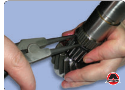
23. Снять с вала игольчатый подшипник, как показано на фото ниже.
