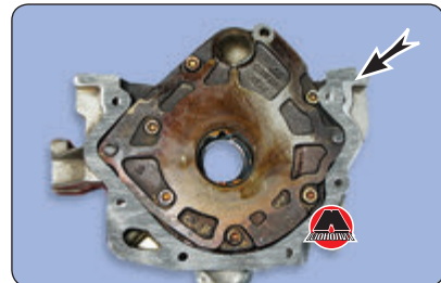
46. Установить крышку на блок цилиндров.
