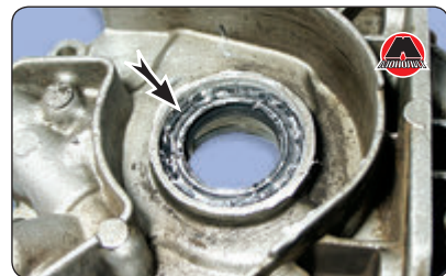
45. Установить новую прокладку на крышку. Издательство «Монолит»
