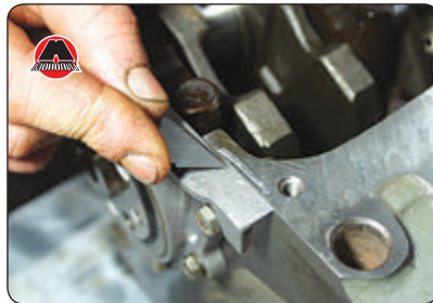
42. С помощью отвертки и молотка выбить старый сальник из передней крышки коленчатого вала/масляного насоса.
