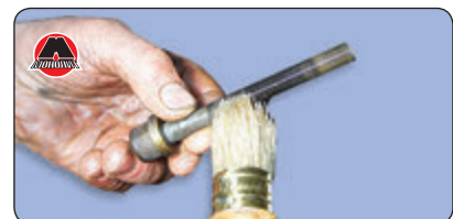
5. Нанести слой моторного масла на резьбу новых болтов крепления головки блока цилиндров.
