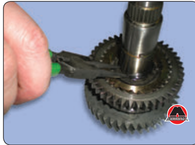
19. Снять с вала шестерню передачи заднего хода/синхронизатор.
