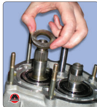
22. Снять стопорное кольцо первичного вала.
