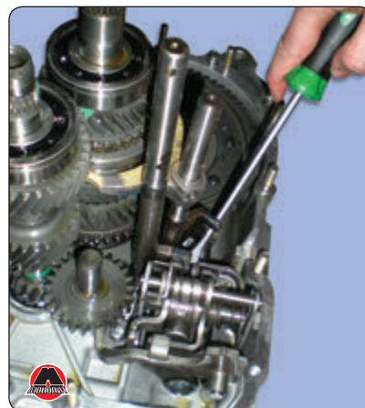
35. Вывести рычаг штока включения пятой передачи из механизма выбора. Снять шток.
