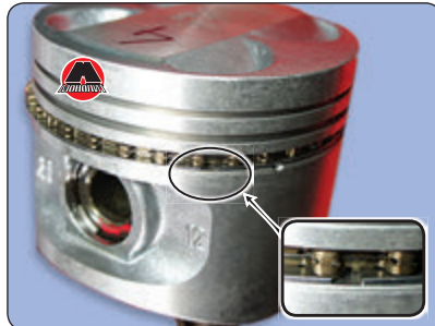
20. Установить на поршень кольца. Установку кольца необходимо начинать с замка.
