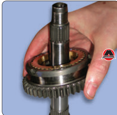
20. Снять коническое кольцо синхронизатора.
