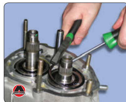
23. Снять стопорное кольцо вторичного вала.
