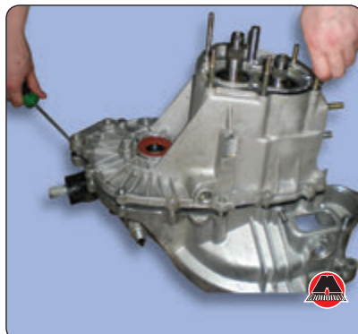
30. Снять корпус коробки передач.
