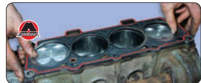
Примечание Направляющие втулки должны войти в соответствующие отверстия прокладки.
