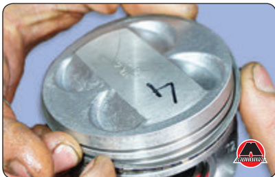
22. Аналогично установить поршневые кольца на остальные поршни. 23. Нанести тонкий слой моторного масла на поршень с кольцами.
