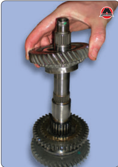
17. Снять игольчатый подшипник шестерни второй передачи.
