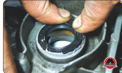
44. Удалить остатки герметика чистой ветошью.
