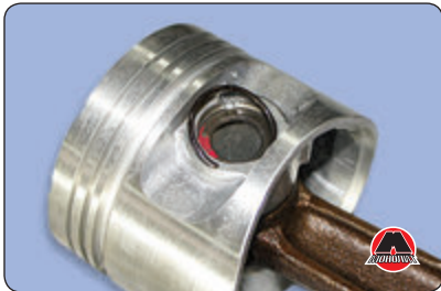
20. Установить на поршень кольца. Установку кольца необходимо начинать с замка.
