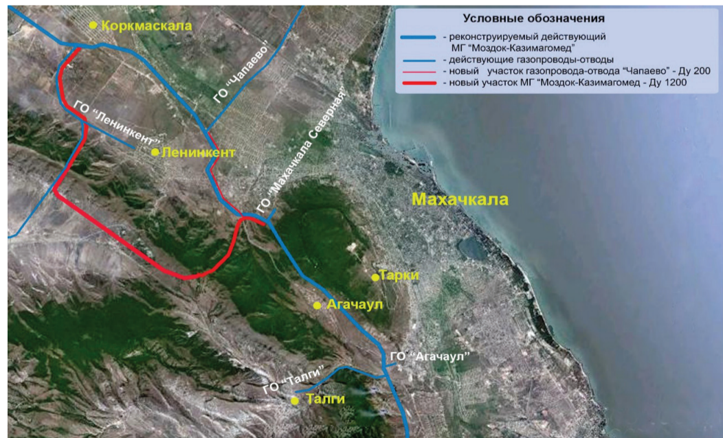
Обзорная схема реконструкции участка МГ «Моздок – Казимагомед»
