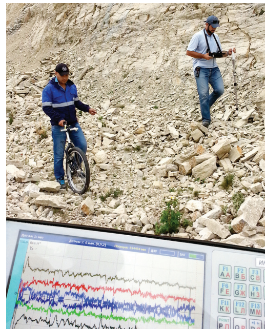
Магнитометрическая диагностика напряженно-деформированного состояния газопровода-отвода «Хунзах»
