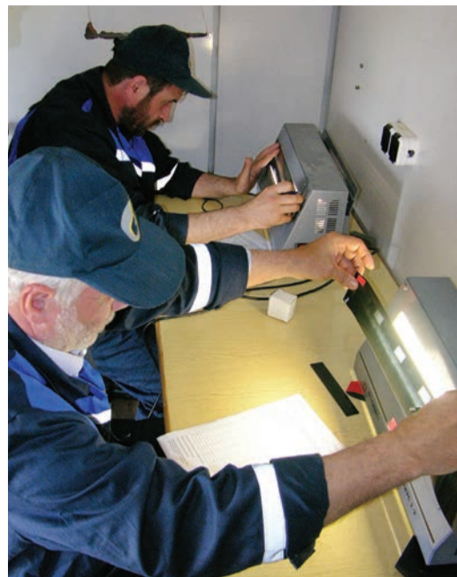
Идет работа по расшифровке рентгеновских снимков сварных соединений
