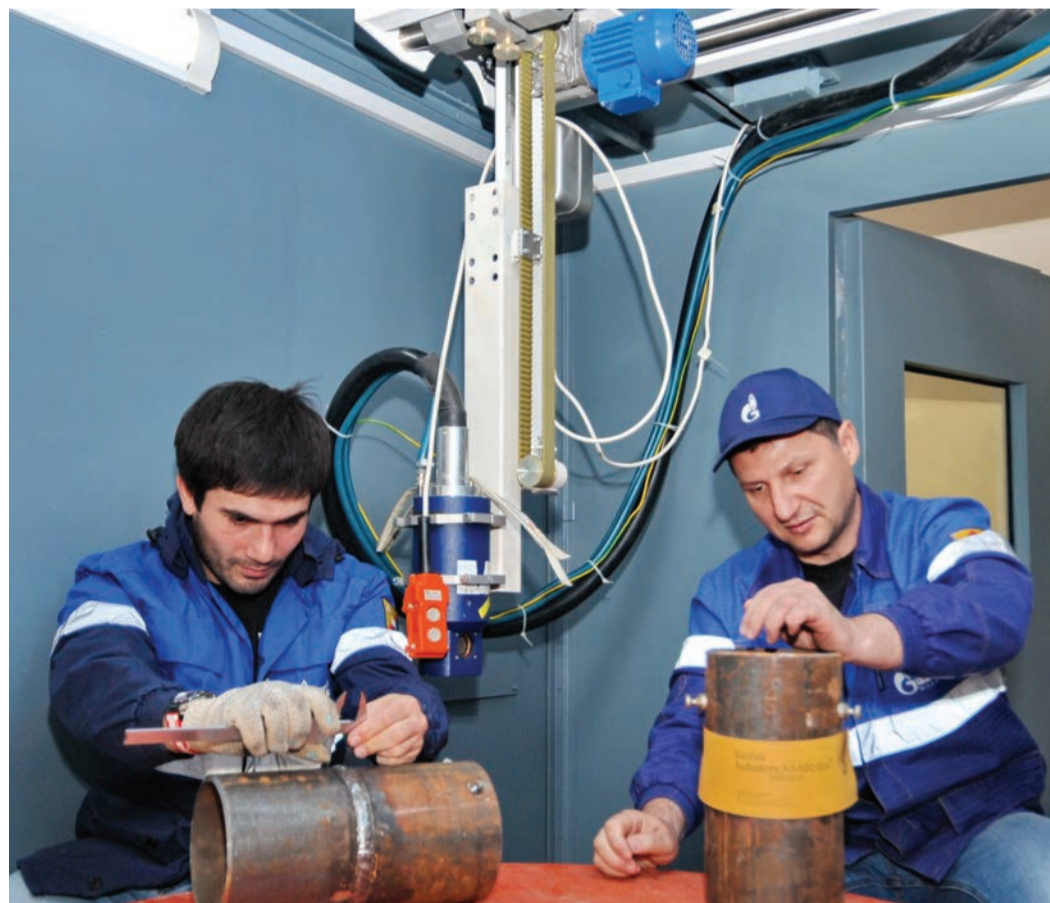
Специалисты неразрушающего контроля Рамис Хасбулатов и Гасанбек Ханбабаев подготавливают катушки с тренировочными стыками к радиационному контролю
