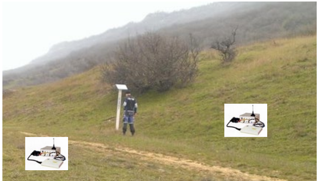
Измерение радиоволнового сигнала регистраторами выше и ниже оси газопровода (слева и справа – используемые для регистрации приборы МГР-01; оператор отмечает километровый столб)
