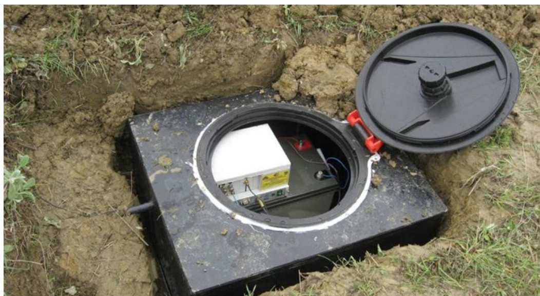
Антивандаальный герметичный бункер с аппаратурой автоматизированного радиоволнового мониторинга опасных геологических процессов
