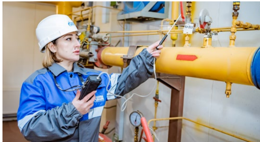
Измерение газоанализатором ФП-22 объемной доли метана в воздухе под манометром на линии низкого давления
