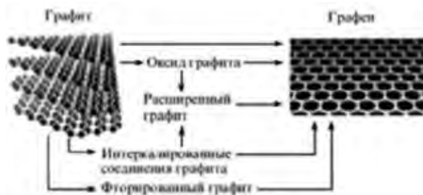
Рис. 4. Схема получения графена из графита. Данные [84].
