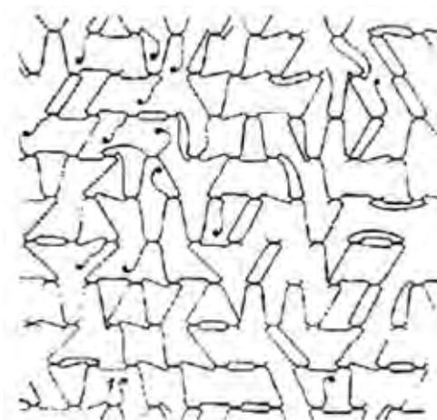
Рис. 8. Двумерная схема сетчатого эпокси-аминного полимера. Чёрные точки – свободные эпоксидные группы. Данные [69].
