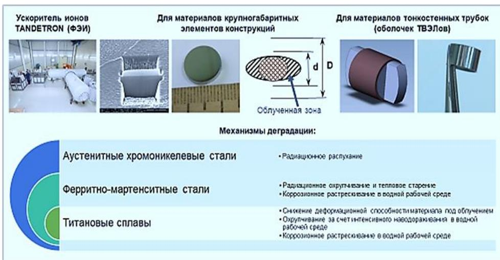
Рис. 5. Ускоренные имитационные исследования радиационной повреждаемости конструкционных материалов (методика)
