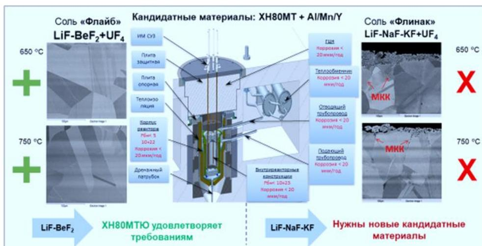
Рис. 13. Примеры: конструкционные материалы для ЖСР
