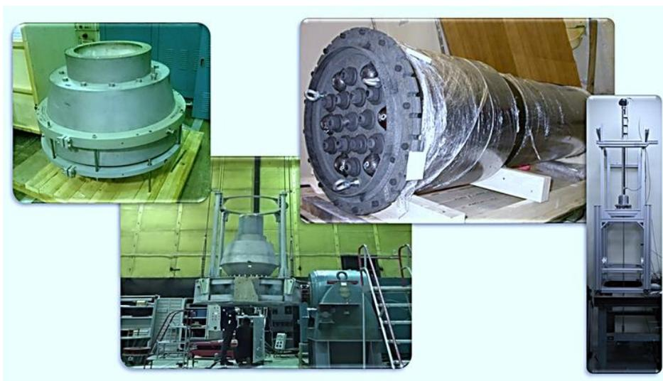
Рис. 9. Блоки внутренней и наружной радиационной защиты
