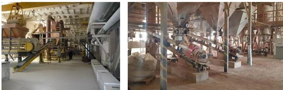
Рис. 2. Промышленная линия ГК «ПИК» для производства дисперсных смесей для установления внутренних и внешних барьеров для вывода из эксплуатации ПУГР ЭИ-2 (ФГУП «СХК»): обогатительная установка ИСА (слева), бункера с системами опорожнения (справа)
