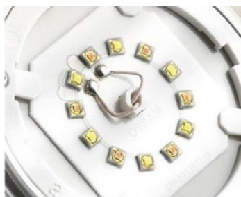
Рис. 1.210. Внешний вид платы светодиодной лампы, выполненной по технологии Brilliant-Mix
